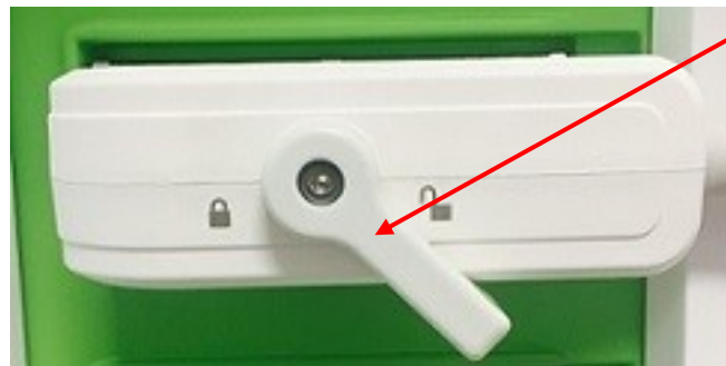
Figur 11: Låseknot for probetilkobling i ulåst posisjon
