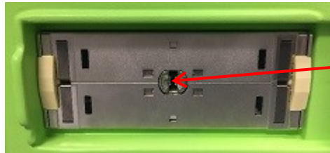
Figur 9: Låsehakk på probetilkoblingssporet
